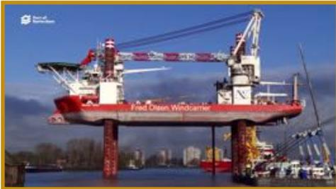
La plateforme auto-élévatrice propulsée "Brave Tern" de 132 m. de long en essai à Rotterdam s'est élevée à 70 mètres au dessus du niveau de la mer.
