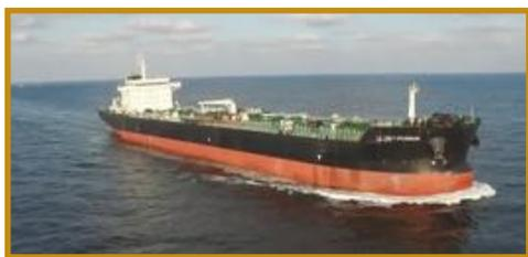
"L'Asphalt Splendor", le plus grand bitumier du monde, classé au BV, avec ses 37 000 tonnes de port en lourd pour 180 m. de long vient d'être livré <https://youtu.be/DlokIahEjoc> à l'armement américain Sargeant Marine <http://valtasphalt.com>. Le bitume liquide, maintenu à chaud, voyage à une température entre 150 et 200° C. Il est réparti dans les 16 cuves indépendantes.
