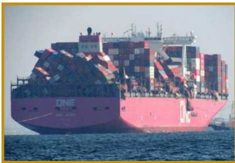
Le "One Apus" à son arrivée à Kobe le 8 décembre 2020 avec plus de 1 800 conteneurs perdus ou endommagés.
