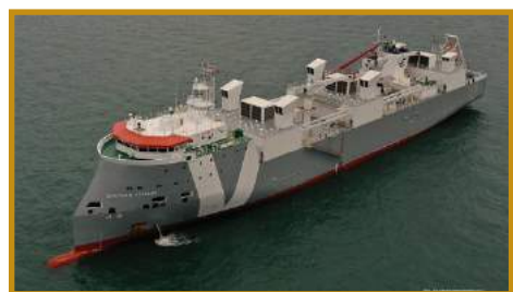
Navire transporteur d'animaux vivants "Greyman Express" (2016) de l'armement Vroon, DWT 5 488, longueur 135 m. largeur 20 m.
