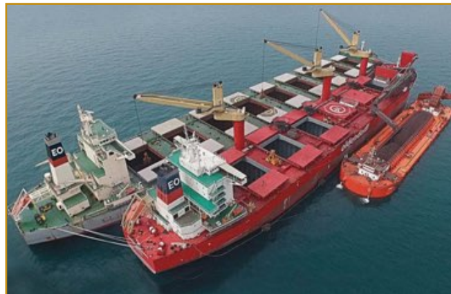
Une belle image technique au large d'Abu Dhabi. Un navire-mère transbordant du minerai depuis un capsize et chargeant sur des barges avec ses grues spécialement adaptées. Voir la vidéo de présentation (3'56") de l'armement allemand Oldendorff : https://goo.gl/DmNA7d
