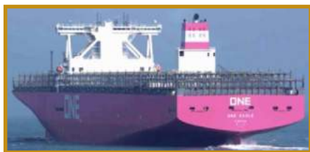
Le porte-conteneur "One eagle" de 364 m. de long et une capacité de 14 000 evp.
